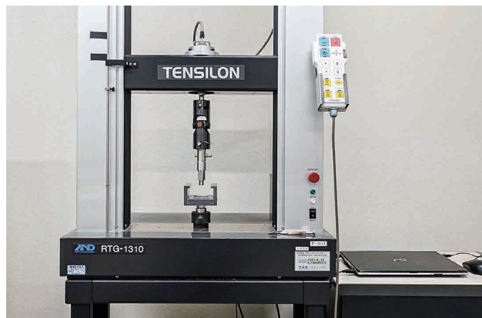
付着強度試験機 材料が十分な付着強度を有しているか計測します。
