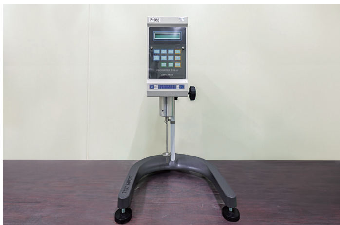
粘度計 良好な施工性を保つため材料の粘度が一定か確認します。
